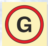
Аварийный источник электроэнергии (генератор) IMO10.116FC
