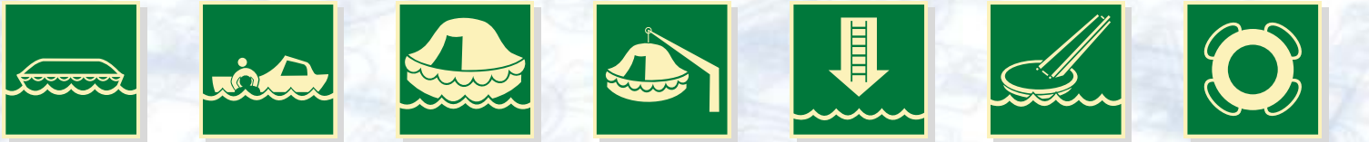
Спасательная шлюпка IMO2.1ФС Дежурная шлюпка IMO2.2ФС Спасательный плот IMO2.3ФС Спасательный плот спускаемого типа IMO2.4ФС Посадочный штормтрап IMO2.5ФС Скат для эвакуации IMO2.6ФС Спасательный круг IMO2.7ФС
