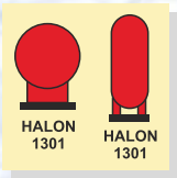
Баллоны с галоном 1301, расположенные в защищаемом помещении ИМО3.50ФС
