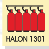
Батарея галона 1301 ИМО3.10ФС
